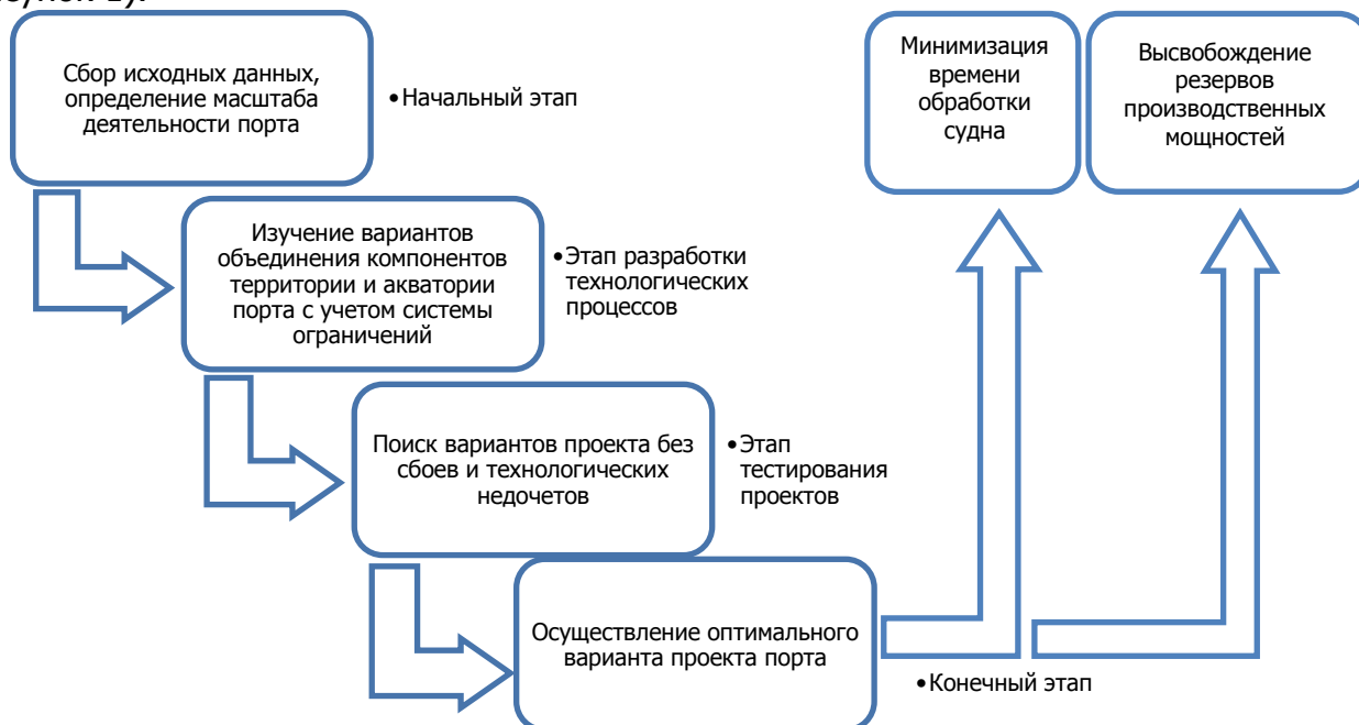
Рисунок 1 – Основные этапы технологического проектирования морских портов
