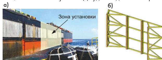
Рис. 5. Схема установки упора на судно: а — зона установки на борту, б — ферменная конструкция — упор
