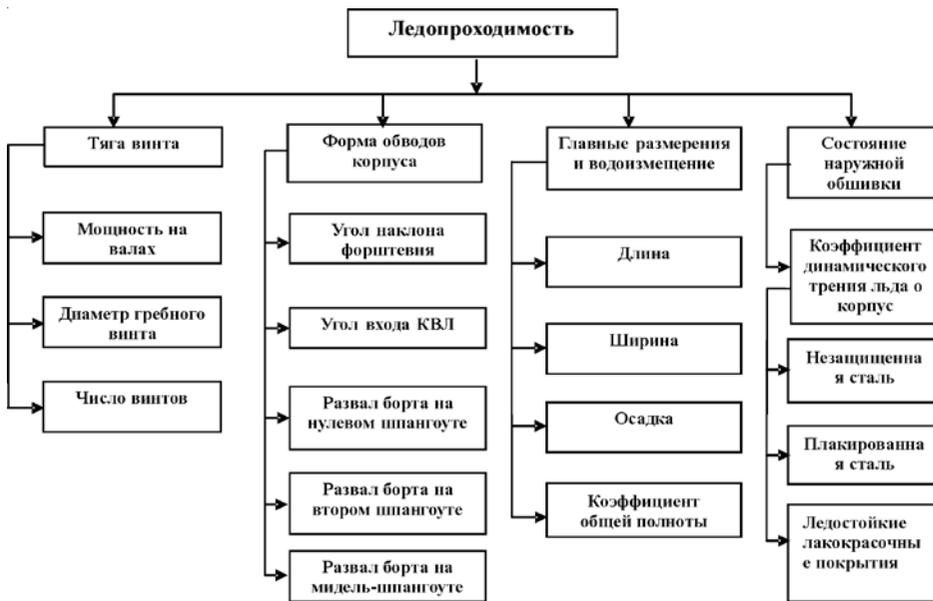
РИС. 1. ОСНОВНЫЕ ФАКТОРЫ, ОТ КОТОРЫХ ЗАВИСИТ ЛЕДОПРОХОДИМОСТЬ СУДНА
