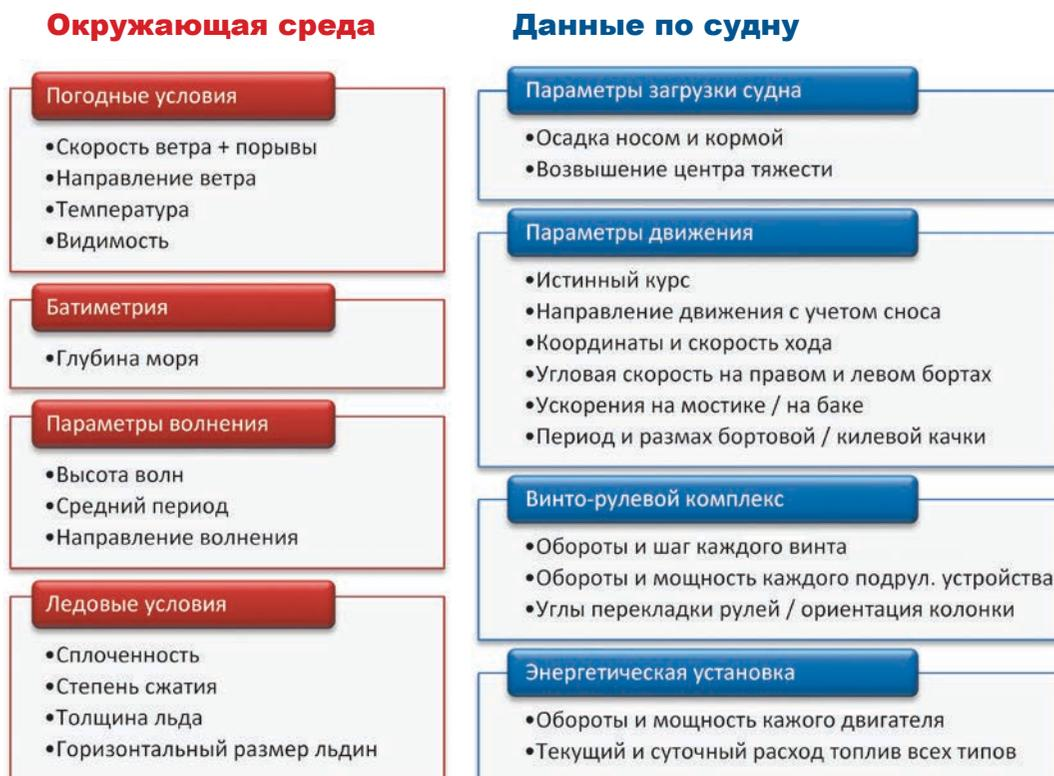
Рис. 3. Ориентировочный перечень параметров, которые следует измерять бортовым регистратором данных рейса во льдах
