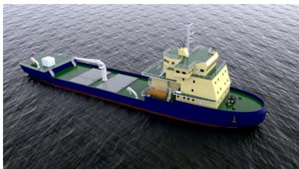
Рисунок 1- Арктическое судно-снабженец дедвейтом до 5 тыс. тонн самостоятельного ледового плавания (проект 1878М)
