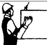
1. Поднять груз или грузозахватный орган (грузозахватное приспособление).
