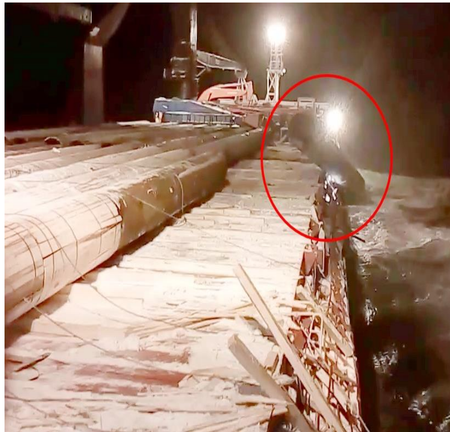
Рис. 19. Положение штабелей и прокладок под ними на Правом борту при падении последней сваи.
