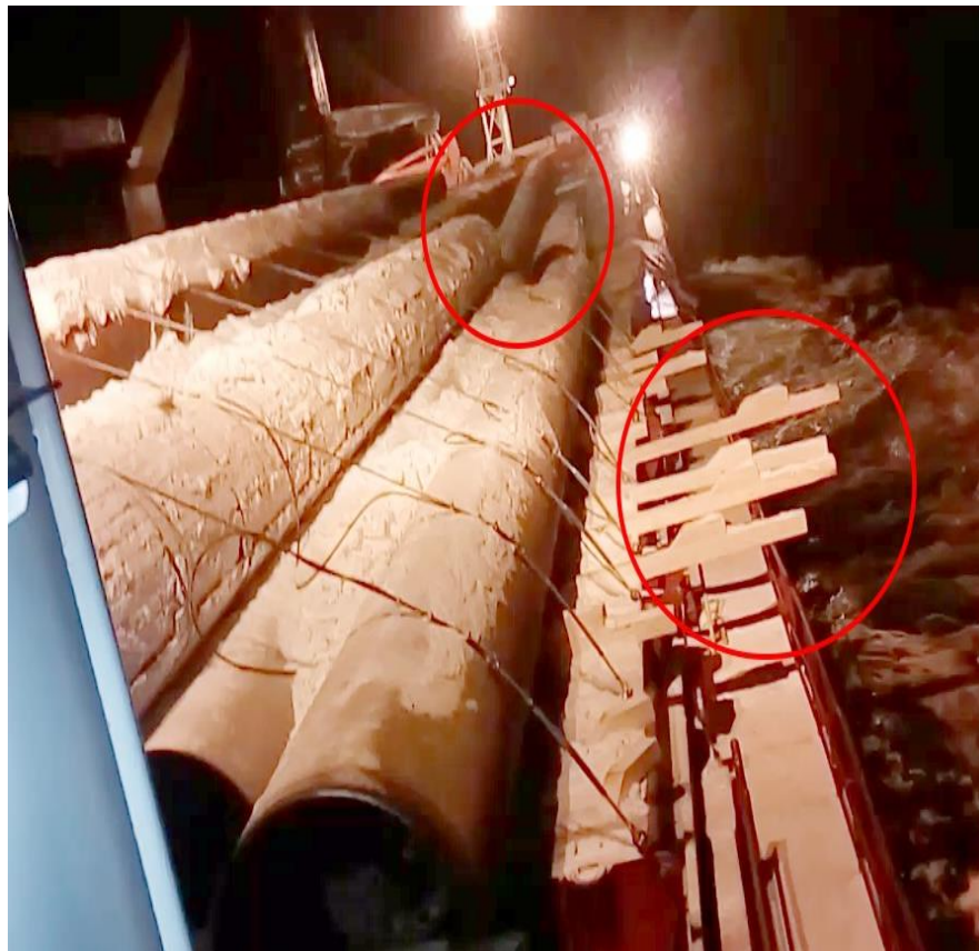
Рис. 18. Положение штабелей свай и прокладок под ними на Правом борту после падения шпунта за борт.
