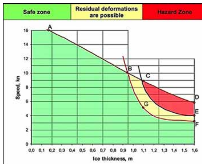
Рис. 2. Определение безопасной скорости хода судна во льдах:
