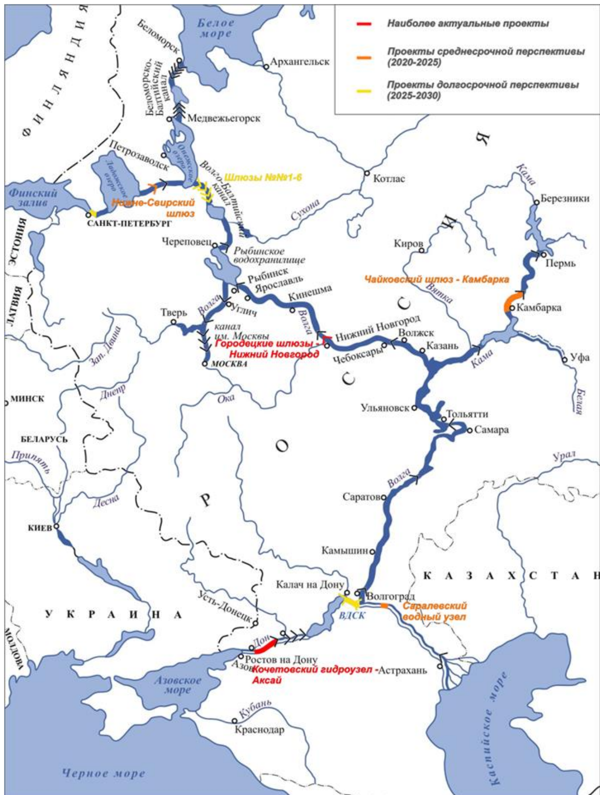
Рис. 7 Последовательность реализации проектов по ликвидации «узких мест» на ЕГС
