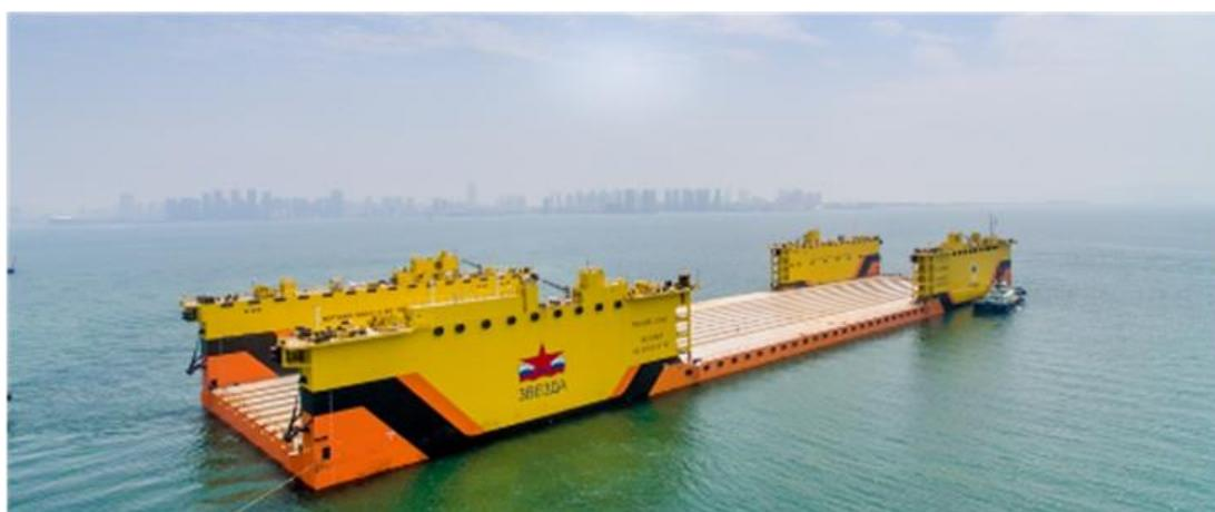
Рисунок 9 – Общий вид плавучего дока ТПД «Вымпел» (длина – 287,3 м, ширина – 65,3 м, осадка максимальная – 26 м, грузоподъемность – 40 000 т)
