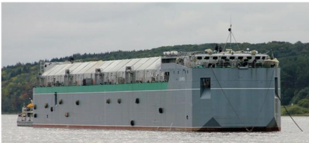
Рисунок 8 – Общий вид плавучего дока (длина – 134 м, ширина – 14 м, осадка – 2,67 м, грузоподъемность – 3300 т)
