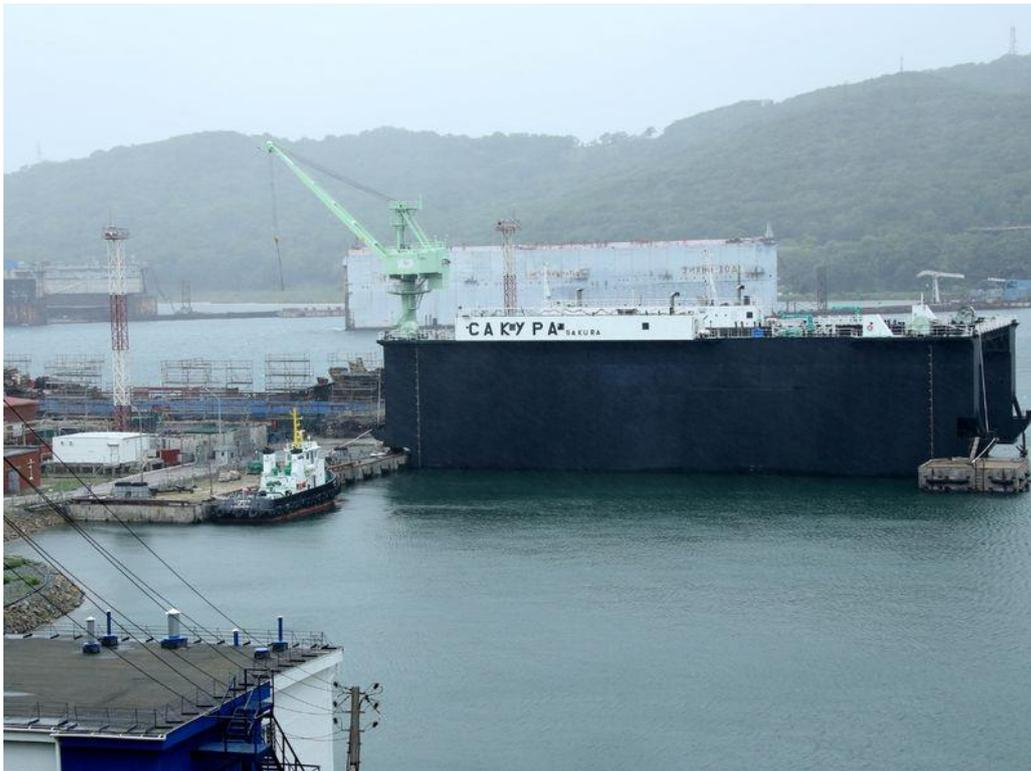
Рисунок 6 – Общий вид плавучего дока ТПД «Сакура» (длина – 76 м, ширина – 30,1 м, осадка – 20,8 м, максимальная глубина погружения – 22,1 м, грузоподъемность – 3500 т)
