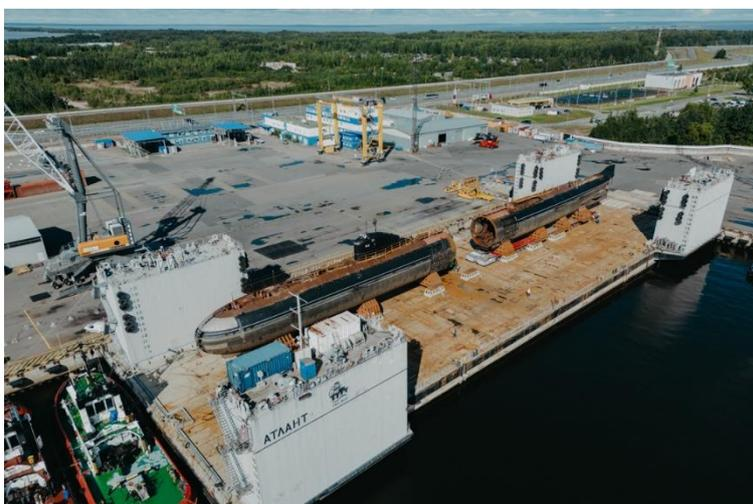
Рисунок 12 – Подготовка АПЛ К-3 к выгрузке на самоходных осях на МГТ «Моби Дик»
