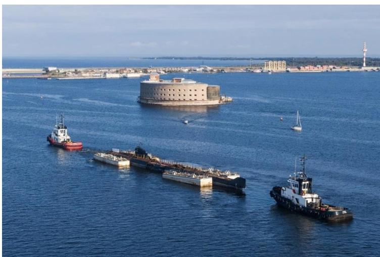
Рисунок 7 – Буксировка АПЛ К-3 из Кронштадта в Выборгский залив. По бортам лодки понтоны СПП-200
