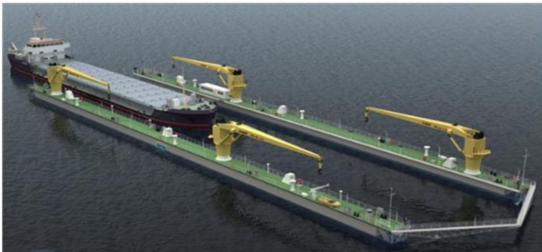
Рисунок 7 – Общий вид плавучего дока «Итарус» (длина – 85 м, ширина – 31,2 м, осадка – 24,5 м, грузоподъемность – 3500 т)
