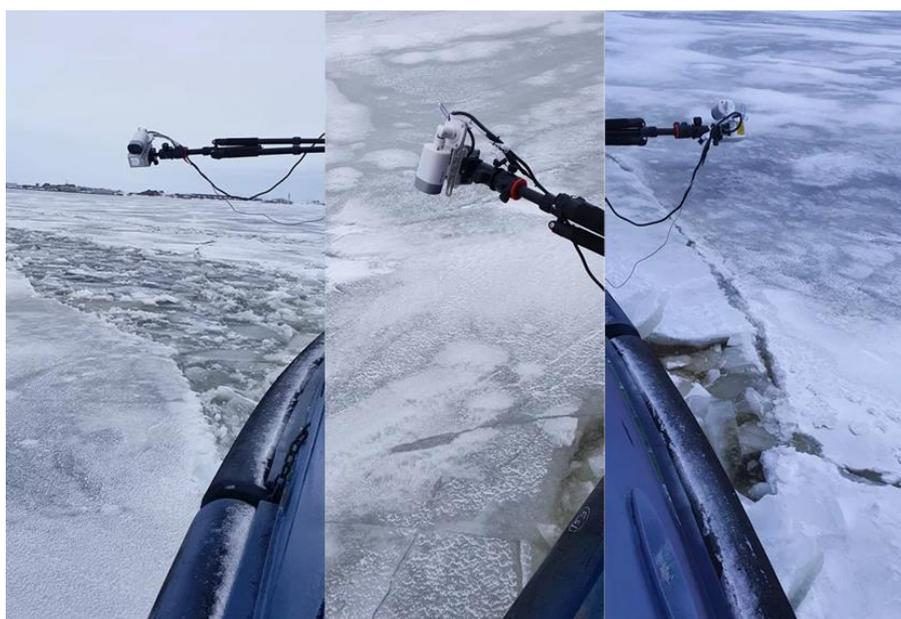
Рисунок 5 – Пример установки и крепления лидара для проведения экспериментов на судне (борт)
