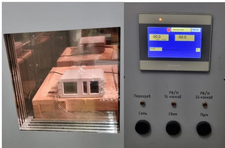
Рисунок 11 – Измерительный блок БИК ЛО в термокамере при температуре -50 °С
