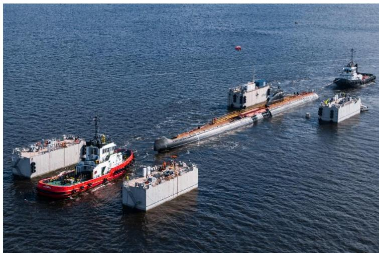
Рисунок 8 – Операция заводки и позиционирования АПЛ К-3 над палубой ППБ «Атлант»
