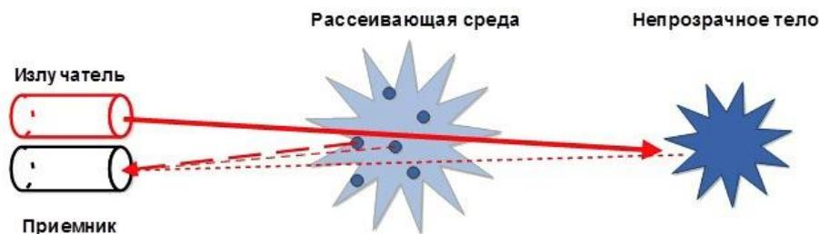
Рисунок 1 – Принцип действия лидара [4]
