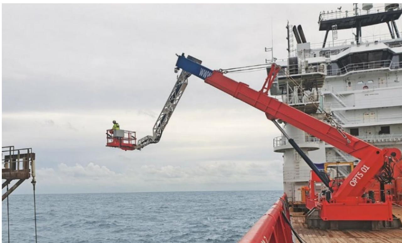
Рисунок 7 – Крановая система OPTS для пересадки персонала от компании Palfinger
