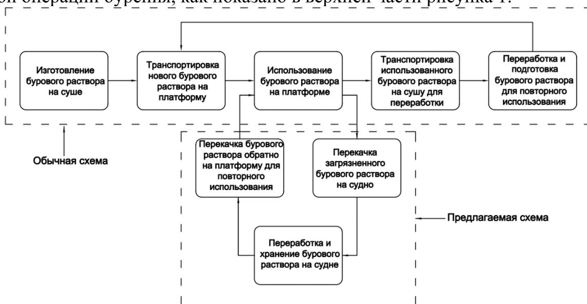
Рисунок 1 – Стандартная и предлагаемая схема транспортировки бурового раствора
