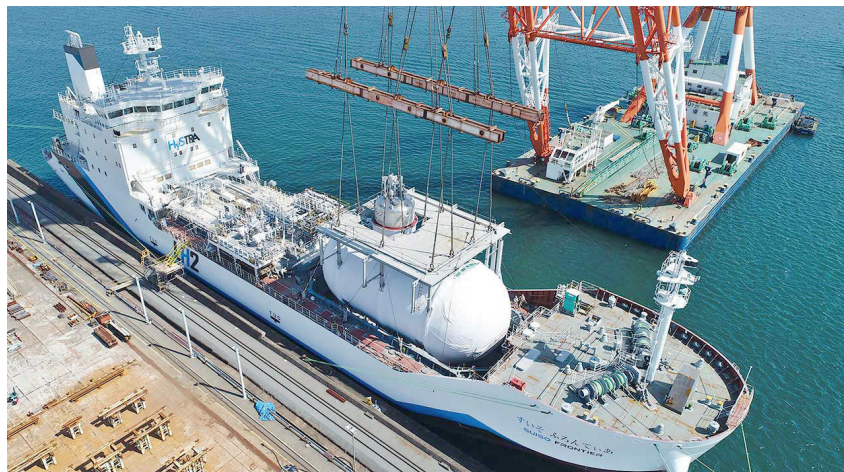
Рис. 2. Грузовой танк газовоза для транспортировки сжиженного водорода Suiso Frontier [8]
