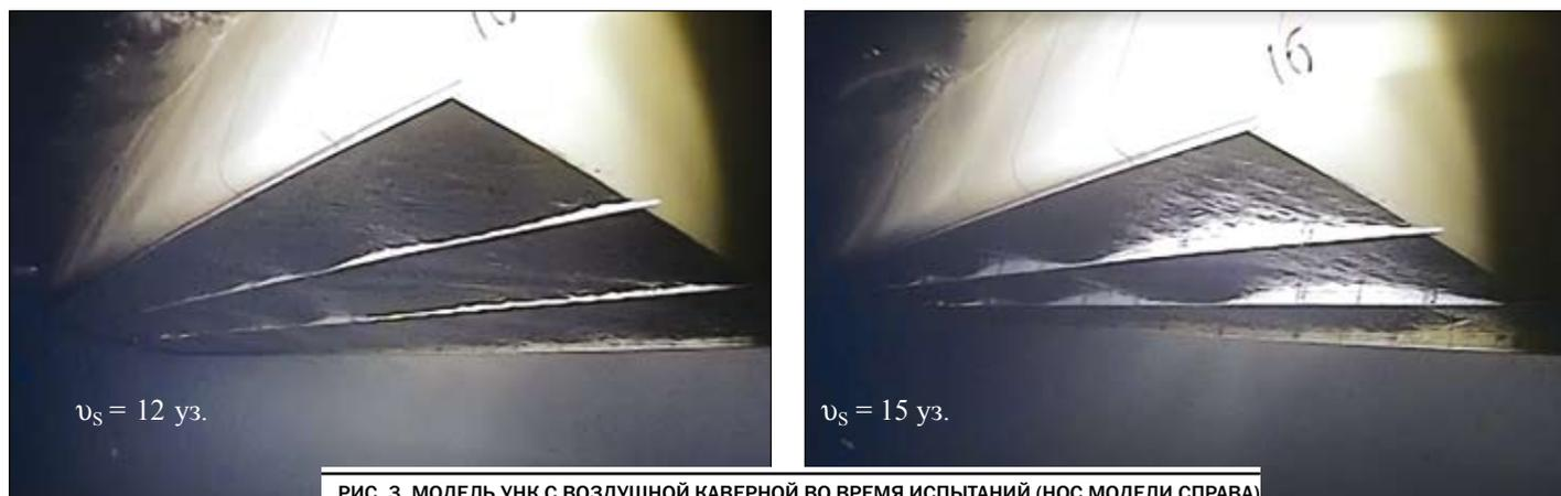
РИС. 3. МОДЕЛЬ УНК С ВОЗДУШНОЙ КАВЕРНОЙ ВО ВРЕМЯ ИСПЫТАНИЙ (НОС МОДЕЛИ СПРАВА)
