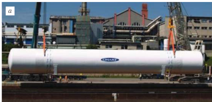
Емкости для хранения газа на судне: а) вкладные цистерны типа С (криогенный топливный танк вместимостью 125 м 3 (Chart Ferroх, Норвегия); б) контейнер-цистерны (контейнер-цистерна КЦМ-35/0,6, ОАО «Уралкриомаш»)
