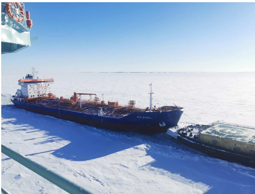
Рис. 1 Буксировка судна «на усах» АЛК «Таймыр» (фото: АО «ЦНИИМФ»)
