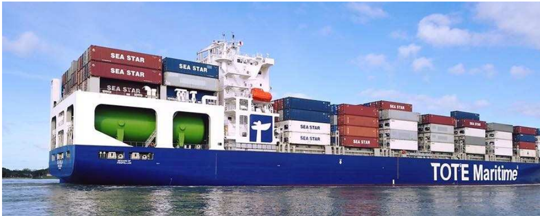
Рис. 5. Размещение СПГ-емкостей на палубе контейнеровоза Isla Bella [9]
