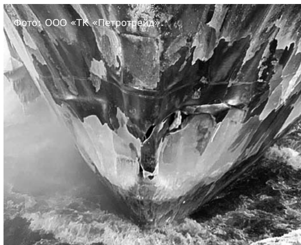
Рис. 3. Пример повреждения носовой оконечности судна в результате буксировки «на усах»
